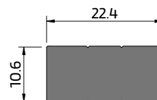
VO 21 Perfil de ligação Perfil anodizado - Preto Connection profile Anodised profile - Black Profilé de liaison Profilé anodisé - Noir
