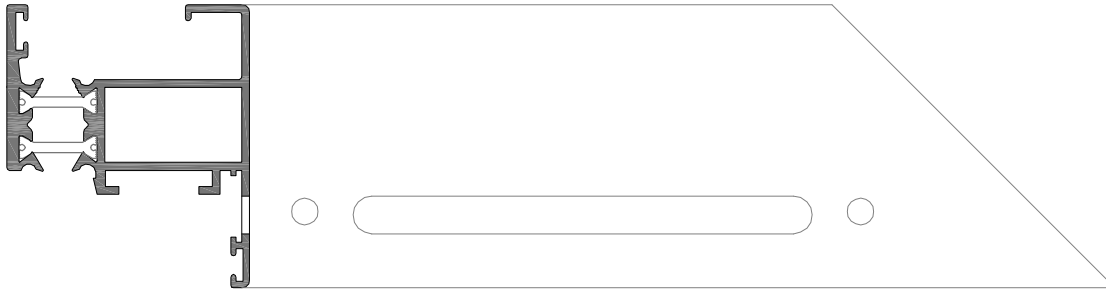
MECANIZAÇÃO PARA FIXAÇÃO DO CREMONE ← CORTANTE AT
